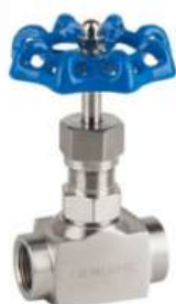
Referentie: 2223 / 2224 Constructie: RVS A182 F316/naald RVS A182 F316 + warmtebehandeling. Gasdraad ISO 228-1 FF. pakking PTFE. Max. werkdruk 210bar. Werktemperatuur -20°C tot 250°C.
