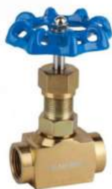
Referentie: 2221 / 2222 Constr. staal A105, naald RVS A182 F316 + Heat Treatment. Gasdraad ISO 228-1 FF. pakking: PTFE Max. werkdruk 210bar. Werktemperatuur -20°C tot 250°C.
