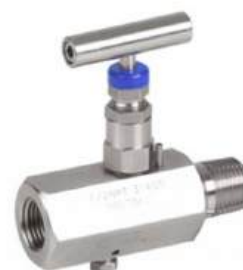
Referentie: 2226 / 2226N Constructie: RVS A182 F316 / Naald RVS A182 F316 + Warmtebehandeling. Schroefdraad ISO 228-1. pakking ptfe. Max. werkdruk 410bar. Werktemperatuur -54°C tot 250°C.
