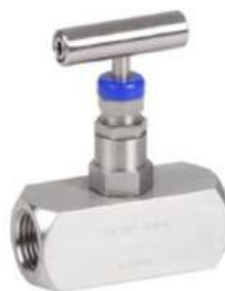
Referentie: 2225 / 2225N Constructie: RVS A182 F316 / Naald RVS A182 F316 + Warmtebehandeling. Draad ISO 228- 1. Stapelpakking PTFE. Max. werkdruk 410bar. Werktemperatuur -54°C tot 250°C.
