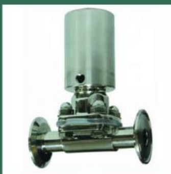
Membraanklep klem- uit einden pneumatisch bediend. Veerretour aandrijving NC Referentie: 2946
